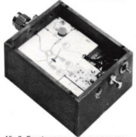
Afb. 7. Een downconverter in hybride microstriptechniek, ontworpen als ontvanger voor de OTS- en ECS-satellieten in de band van 11,4...11,7 GHz. Linksboven de transistoroscillator, gestabiliseerd met een diëlektrische resonator. In het midden de gebalanceerde mengtrap en rechts de middenfrequentversterker (foto Philips-Elcoma).
