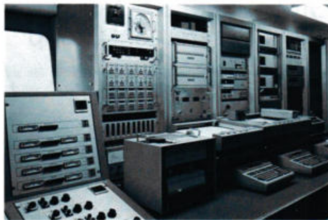
Het Jan Heijmans survey-systeem is geconfigureerd rond drie HP 9825T desktop computers met veel Hewlett-Packard- en andere randapparatuur. Zichtbaar zijn twee HP 6940B multiprogrammers en twee HP 9872S plotters.
