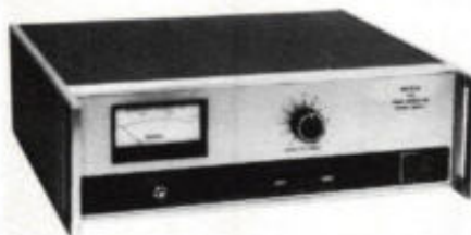
Afb. 11. De hoogspanningsvoeding Ailtech 7175 voor gasontladingsruisbronnen kan zowel in een „conventionele“ alsook in een automatische meetopstelling worden gebruikt.
