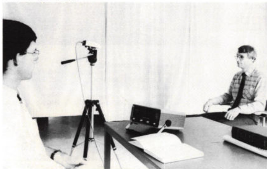
Afb. 1. Voor meting van onwillekeurige bewegingen wordt de patiënt geplaatst in een microgolfbundel van lage intensiteit.
