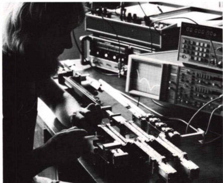
Metingen aan een uitgangsmultiplexer voor de satelliet TV-SAT in een laboratorium van AEG-Telefunken. Dit filternetwerk heeft tot taak om vijf kanalen van groot vermogen gezamenlijk aan de zendantenne toe te voeren. Microgolfmeettechniek is een specialistische materie, door de TH-Twente geadopteerd als onderzoeksgebied.
