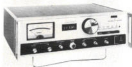
Afb. 14. Voor de precisie Y-factor meting, bijv. met de Hot/Cold Load, kan de Ailtech 13611 Precision Test Receiver worden gebruikt.
