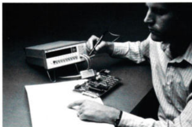
De nieuwe HP 5006A Signature Analyzer is programmeerbaar via HP-IL (Hewlett-Packard Interface Loop). Een parallelle HP-IB interface (IEEE 488) is eveneens beschikbaar.
