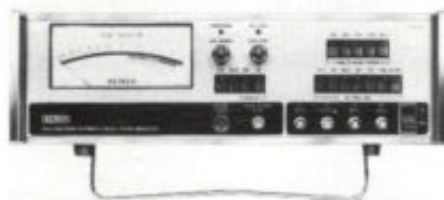
Afb. 15. De Ailtech 7514 Precision Automatic Noise Figure Indicator, met directe analoge ruisgetal aanwijzing, heeft een instrument onnauwkeurigheid van \pm 0,05 dB voor lage ruisgetallen.
